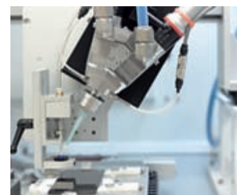
Der innovative Applikations-Roboter Loctite 4530 HC verklebt elektronische Bauteile präzise und sehr schnell.
